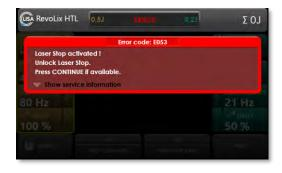
Fig. 58: Error message (example: error code E053)
