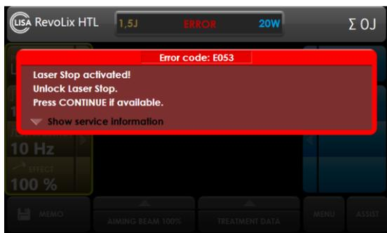
Fig. 56: Error message (example: error code E053)
