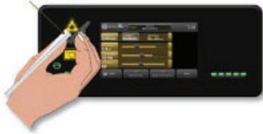
III. 42: Introduisez la fibre dans le couplage à fibre et vissez-la en douceur
