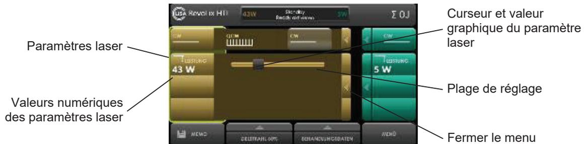
III. 27 : Réglage de paramètres laser, dans le mode CW dans cet exemple
