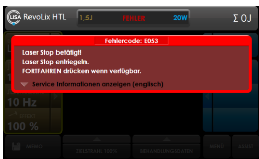
Abb. 56: Fehlermeldung (Beispiel: Fehlercode E053)
