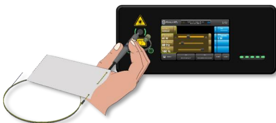
Abb. 40: Faser zum Strahlverschluss führen
