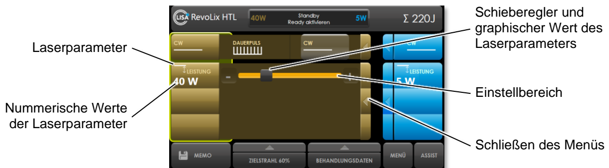
Abb. 27: Einstellung von Laserparametern, hier in der CW Betriebsart
