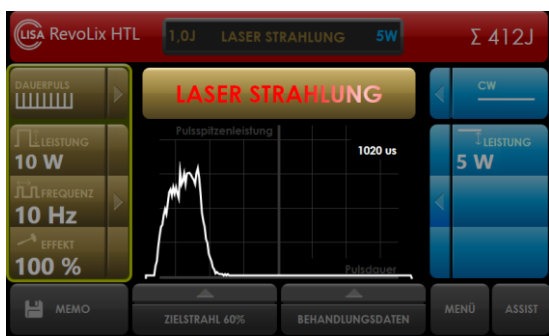
Abb. 29: Pulsform eines kurzen Laserpulses mit einer hohen Pulsspitzenleistung
