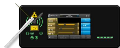
Abb. 43: Die Laserfaser ist erfolgreich angeschlossen
