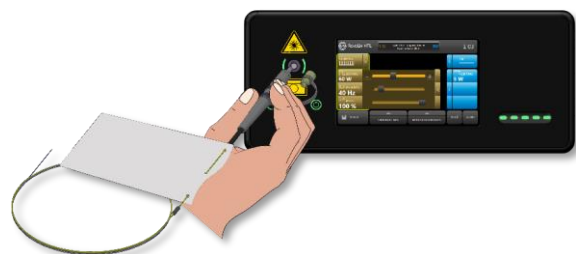
Abb. 41: Strahlverschluss öffnet automatisch
