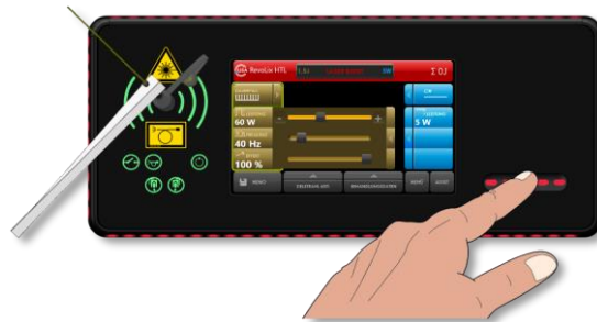
Abb. 51: Umschalten in STANDBY
