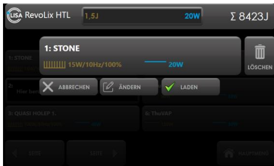
Abb. 36: Laden der voreingestellten Laserparameter
