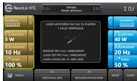
Abb. 45: Informationen über die angeschlossene Faser
