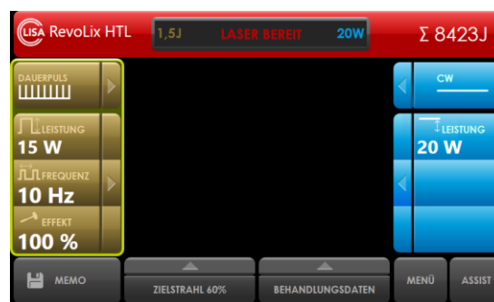
Abb. 49: Die rote Statuszeile zeigt den Betriebszustand READY an.
