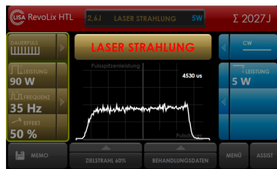
Abb. 30: Pulsform eines langen Laserpulses mit einer niedrigen Pulsspitzenleistung
