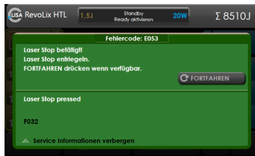
Abb. 58: Meldung nach Beheben des Fehlers
