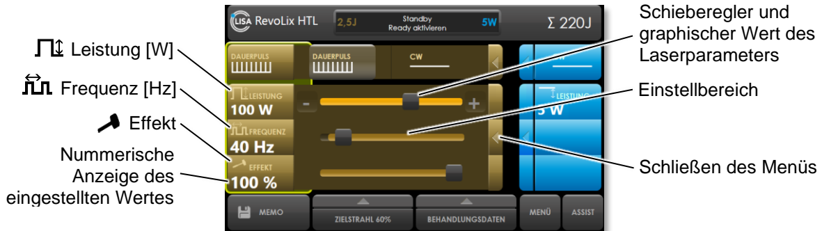
Abb. 28: Einstellung von Laserparametern, hier in der Betriebsart DAUERPULS
