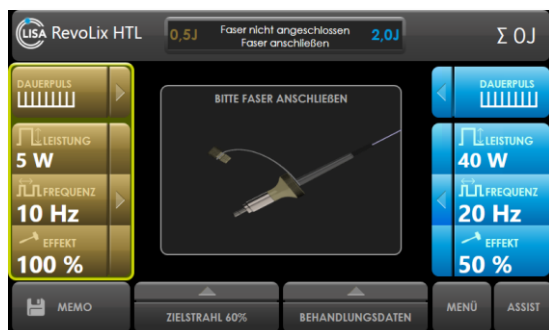
Abb. 44: Startbildschirm, wenn keine RFID-Faser angeschlossen ist
