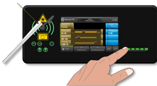
Abb. 47: Wechseln in den Betriebszustand READY
