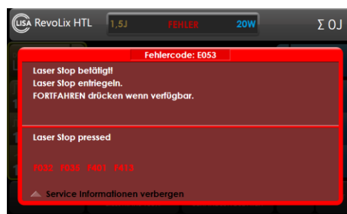
Abb. 57: Fehlermeldung – Service-Information mit F-Code
